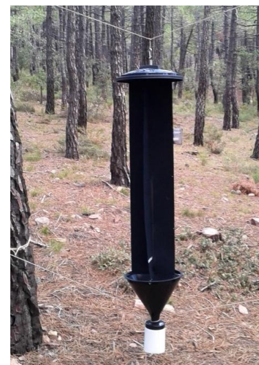
Foto 20. Trampas tipo Cross-Vane y multiembudo para atrayentes kairomonales. Fuente: Servicio de Ordenación y Gestión Forestal de la Dirección General del Medio Natural.
