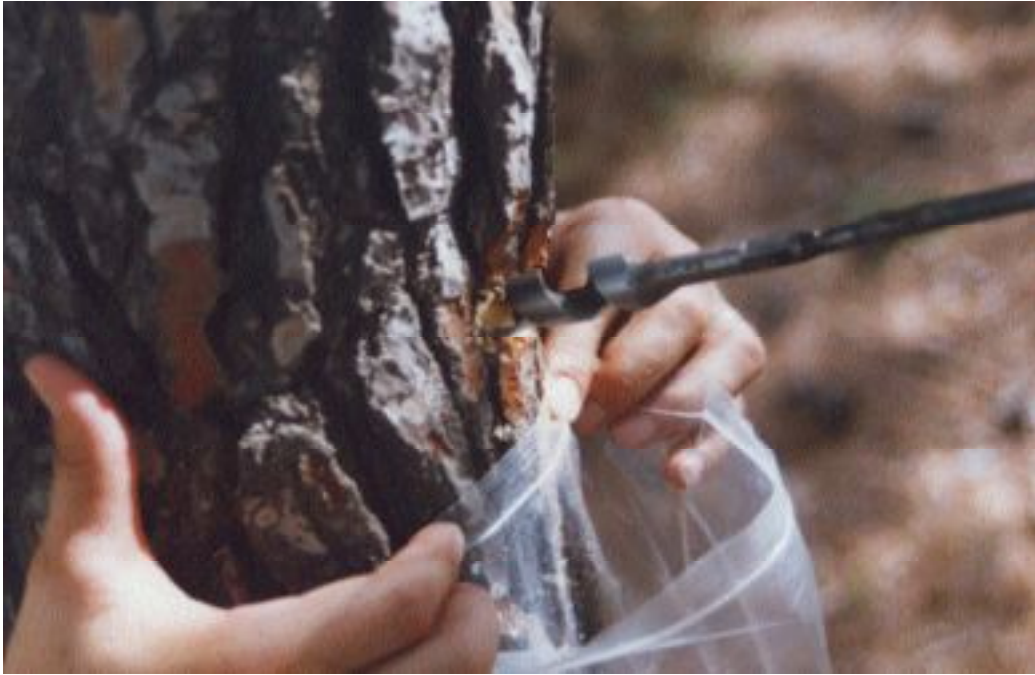
FOTO 2: Detalle de la barrena entrando en el árbol y la bolsa de plástico donde se recogen las virutas de madera.
