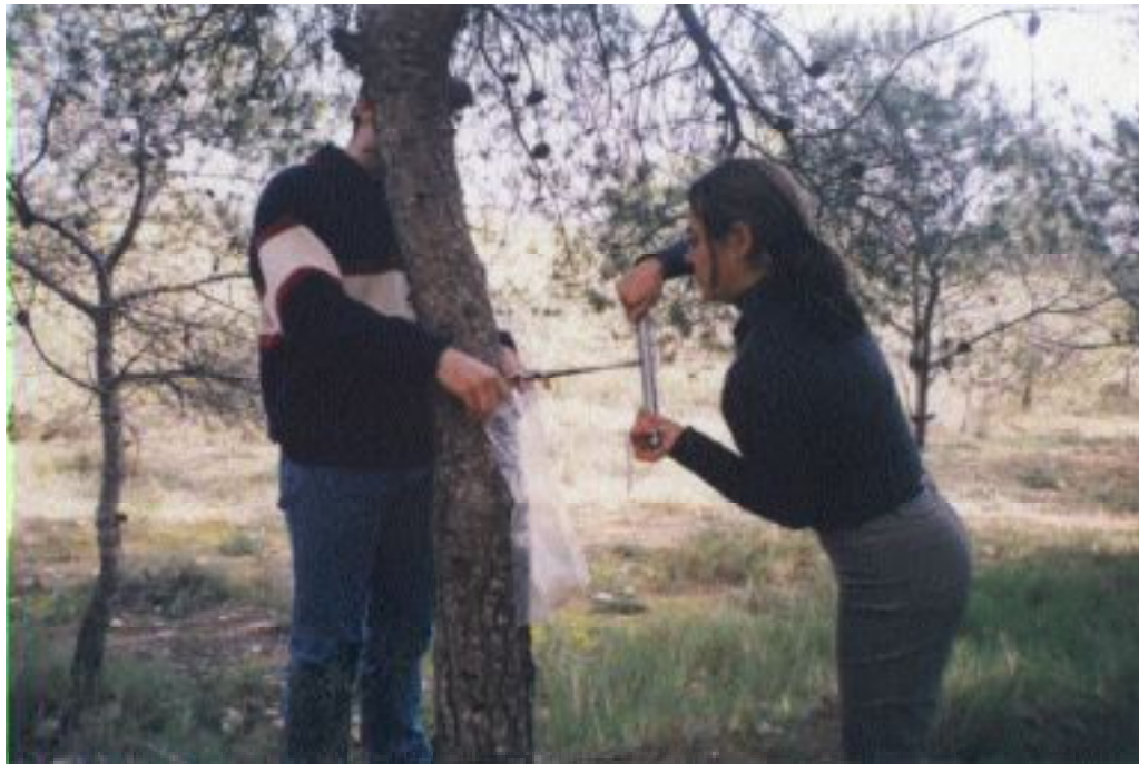
FOTO 1: Proceso de toma de muestra en el que se observa el manejo de la barrena y la bolsa donde se recoge la viruta.
