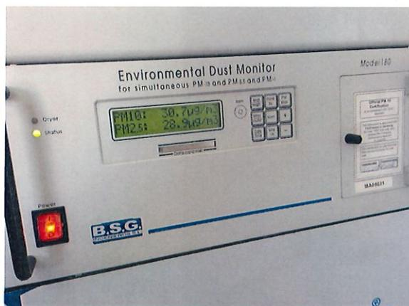
**Figura 3.- Analizador PM10 utilizado en la estación de Molí del Sol (Valencia)**
