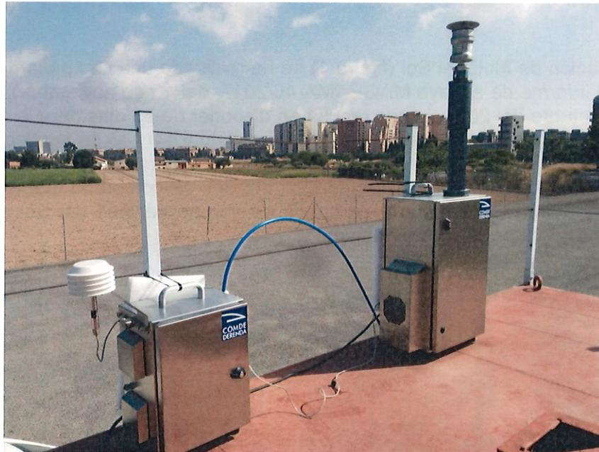
**Figura 2.- Captador PM10 de referencia de bajo volumen con módulo secuenciador de filtros utilizado en Molí del Sol (Valencia)**
