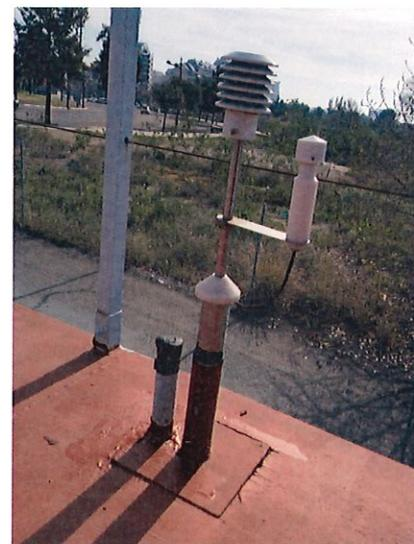
**Figura 4.- Toma de muestra de partículas del analizador utilizado en la estación de Molí del Sol (Valencia)**
