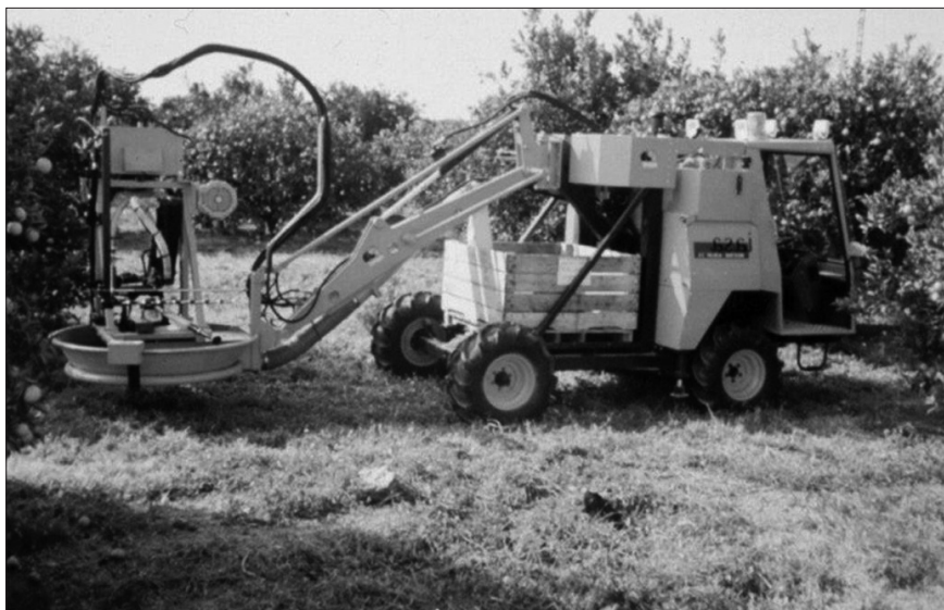
7.11 En 1987 se iniciaron trabajos para la construcción de un robot recolector de naranjas. En la fotografía se presenta el prototipo que se creó. (Foto cedida por E. Moltó).
