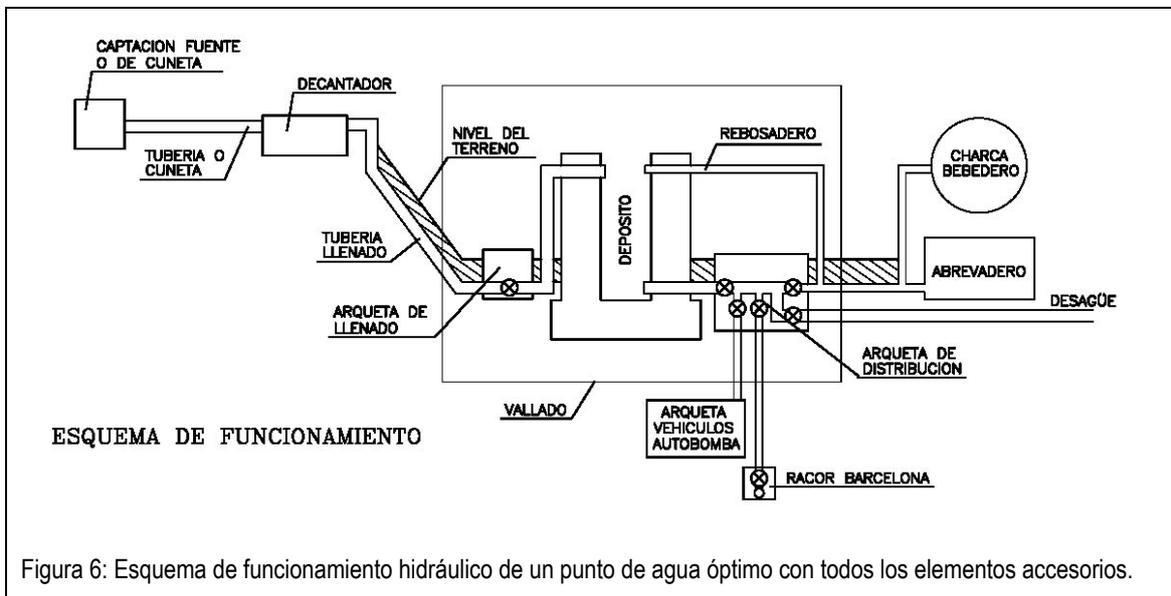
Figura 6: Esquema de funcionamiento hidráulico de un punto de agua óptimo con todos los elementos accesorios.
