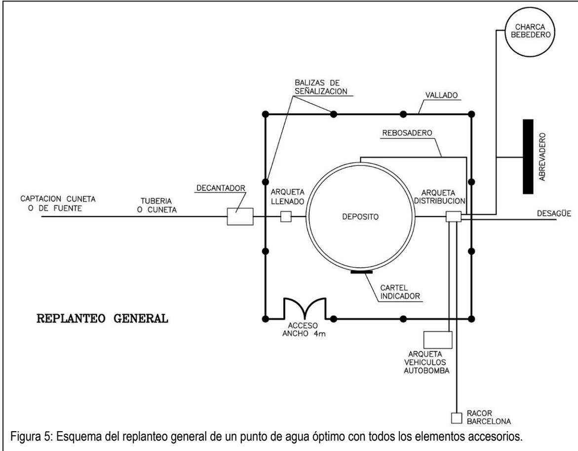
Figura 5: Esquema del replanteo general de un punto de agua óptimo con todos los elementos accesorios.
