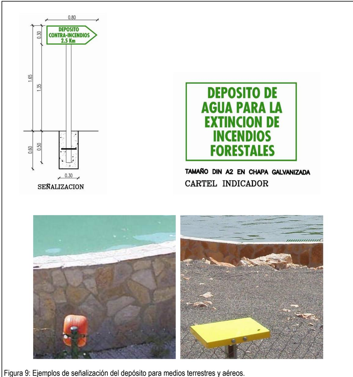
Figura 9: Ejemplos de señalización del depósito para medios terrestres y aéreos.
