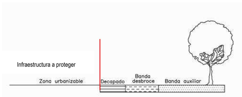
La banda de decapado se situará en el perímetro de la infraestructura a proteger. A continuación de la banda de decapado se sitúa una banda de desbroce y, por último una banda auxiliar.
