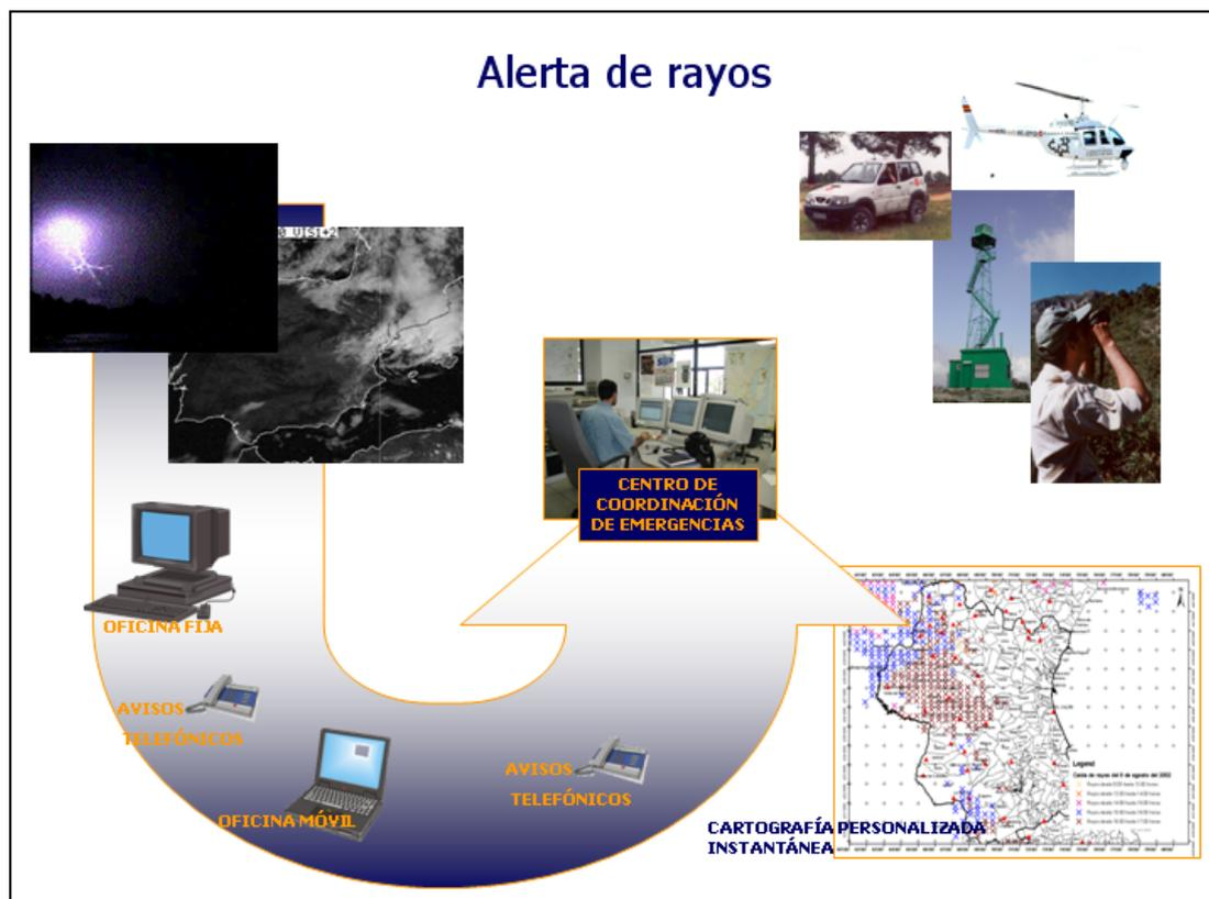
Figura 4. Esquema del funcionamiento de la alerta por rayos.
