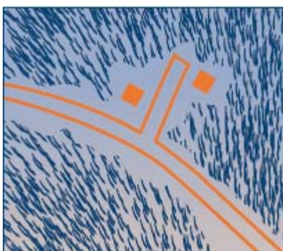
Figura 5. Acceso inadecuado en fondo de saco
