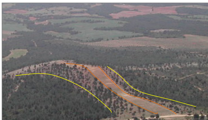
Fotografía 9. Área cortafuegos apoyada en cortafuegos existente (en naranja) y banda auxiliar (en amarillo).
